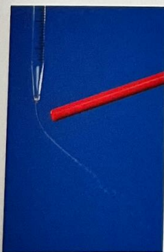
Abb. 2.8: Ablenkung eines Wasserstrahls durch einen aufgeladenen Stab
