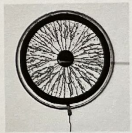
Abb. 2.9: Feld eines Zylinderkondensators, sichtbar gemacht durch Gries
